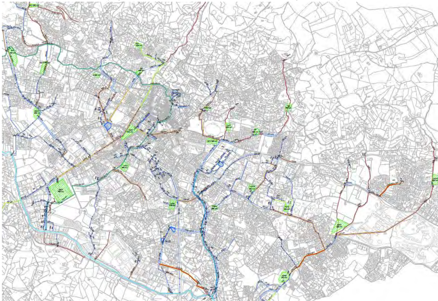
Annexe 1 : Extrait du SDEP de 2013 : programme d'actions (en vert, les bassins de rétention et en orangé, le recalibrage de réseau EP)
